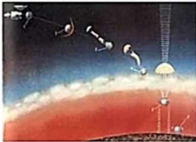
Рис.8. Вход спуск в атмосфере («Венера-4» - «Венера-6»)
